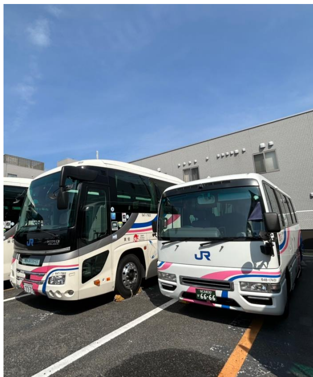
写真：放射冷却素材「Radi-Cool」を施工して走行を予定するバス車両 （左側：施工済みバス車両の一部、右側：Radi-Cool ステッカー貼付）
